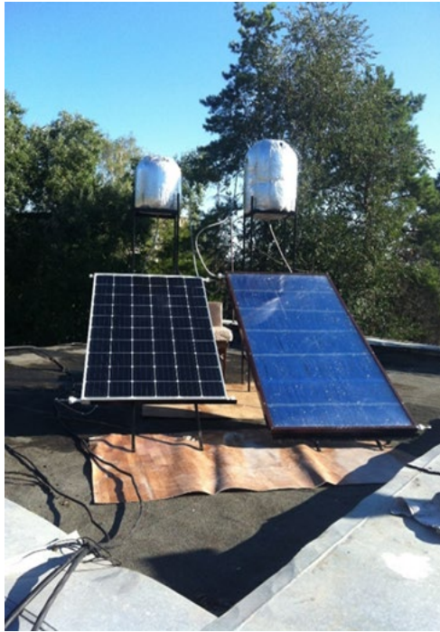
Testare prototipelor PVT și PS
