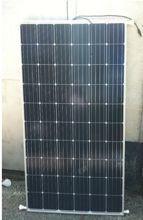
Testare prototipelor PVT și PS
